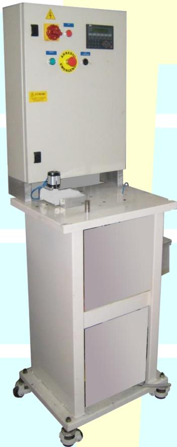
La macchina è stata studiata per eseguire l'inserimento all'interno dell'apposito alloggiamento della calamita e dello spazzolino in diversi tipi di profili in alluminio.
